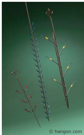
Fot. 4. Na stelażach zawieszkowych oprawy dostosowane do mocowania haków z drutu
